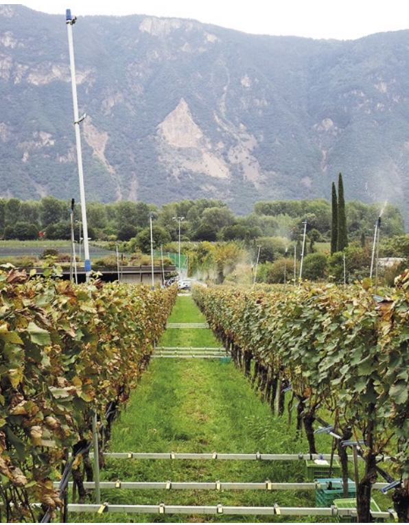
Versuchsaufbau zum Messen der Abdrift am Beispiel der Pilotanlage zur stationären Ausbringung von Pflanzenschutzmitteln am Versuchszentrum Laimburg.
