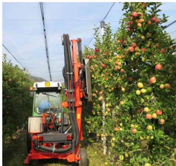
Fig. 1: Macchinario per la sfogliatura meccanica in azione
