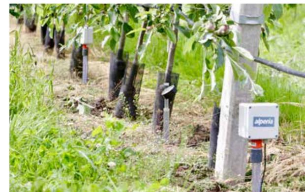
Fig. 1: Sensori per la misurazione della disponibilità idrica del suolo installati in un meleto
