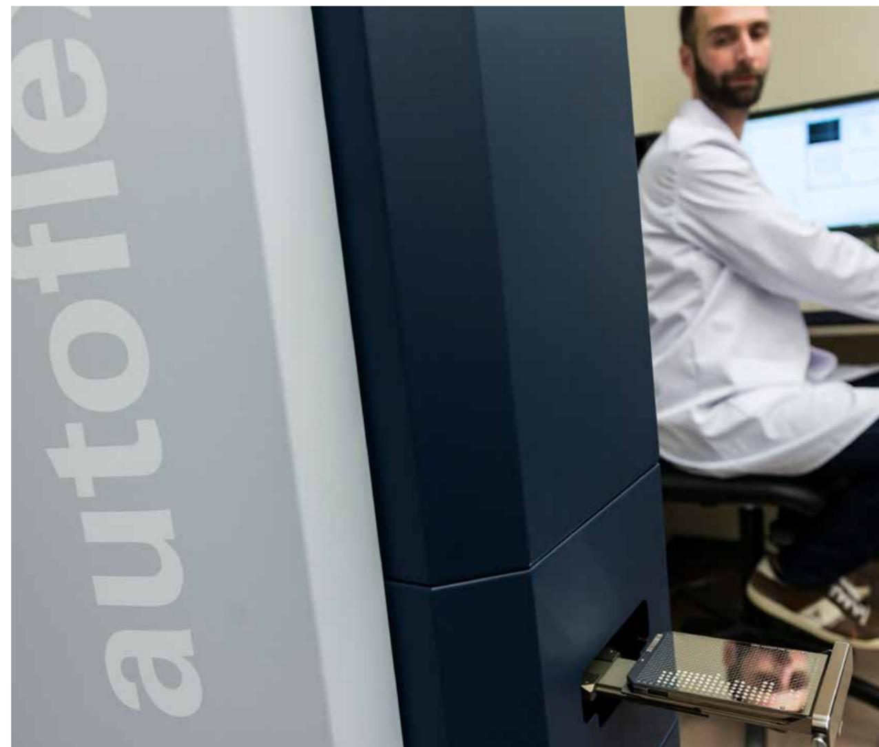
Fig. 1: Lo strumento spettrometro di massa con tecnologia MALDI-TOF per l'identificazione dei microrganismi nei prodotti agroalimentari
