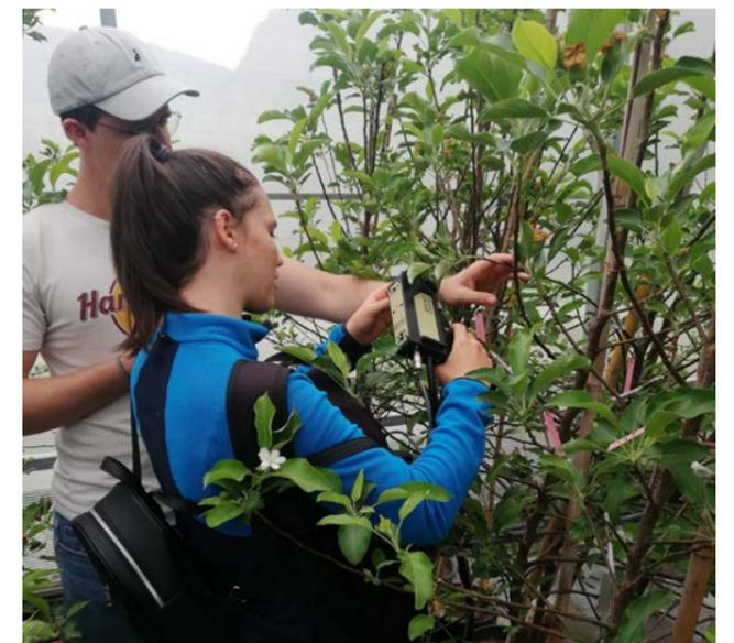
Abb. 3: Erhebung von spektralen Blattprofilen an einem Apfelbaum
