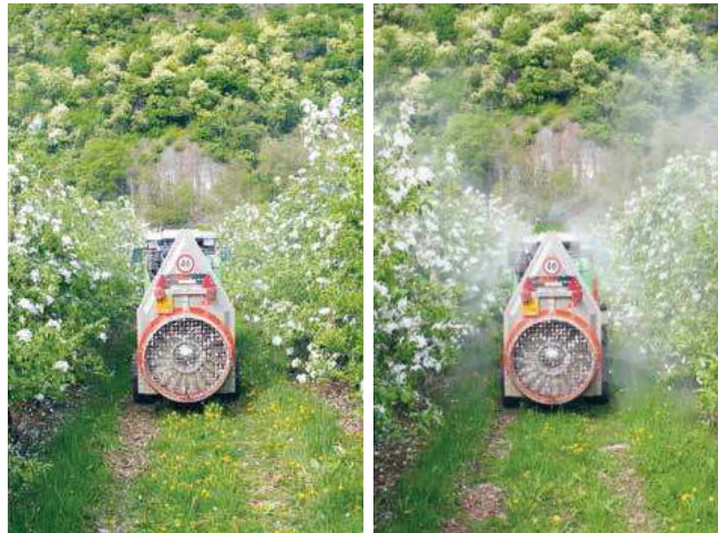
Abb. 1: Bei grobtropfiger Applikation mit ITR 80 – 015 (links) gibt es im Vergleich zu der feintropfigen Düse ATR gelb bei gleichem Brüheaufwand (166 l/m Kronenhöhe und ha) keinen sichtbaren Sprühnebel.
