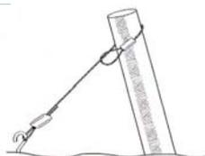
**Ankerdrahtseil „Grippe Anchor fast“:** das Ankerdrahtseil wird mit der Schlaufe am Endpfahl befestigt, das Drahtseil an der Öse des Ankers eingefädelt und mit dem „Grippe maxi“ gespannt. In 3 Stärken erhältlich.
