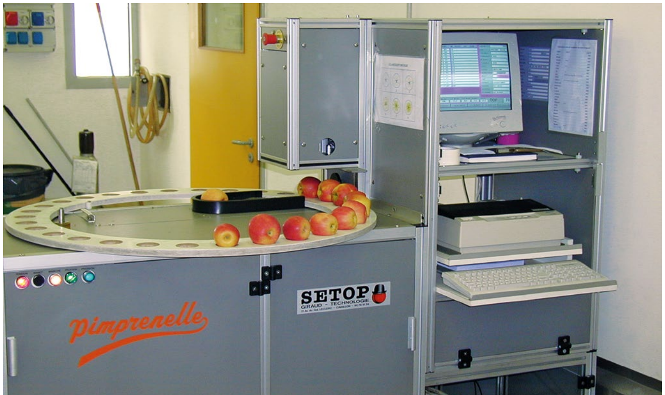
Zur Ernte, Auslagerung und nach shelf life wurden die Festigkeit und die geschmacksgebenden Inhaltsstoffe von Bonita und SQ159/Natyra® mit diesem Gerät gemessen.
