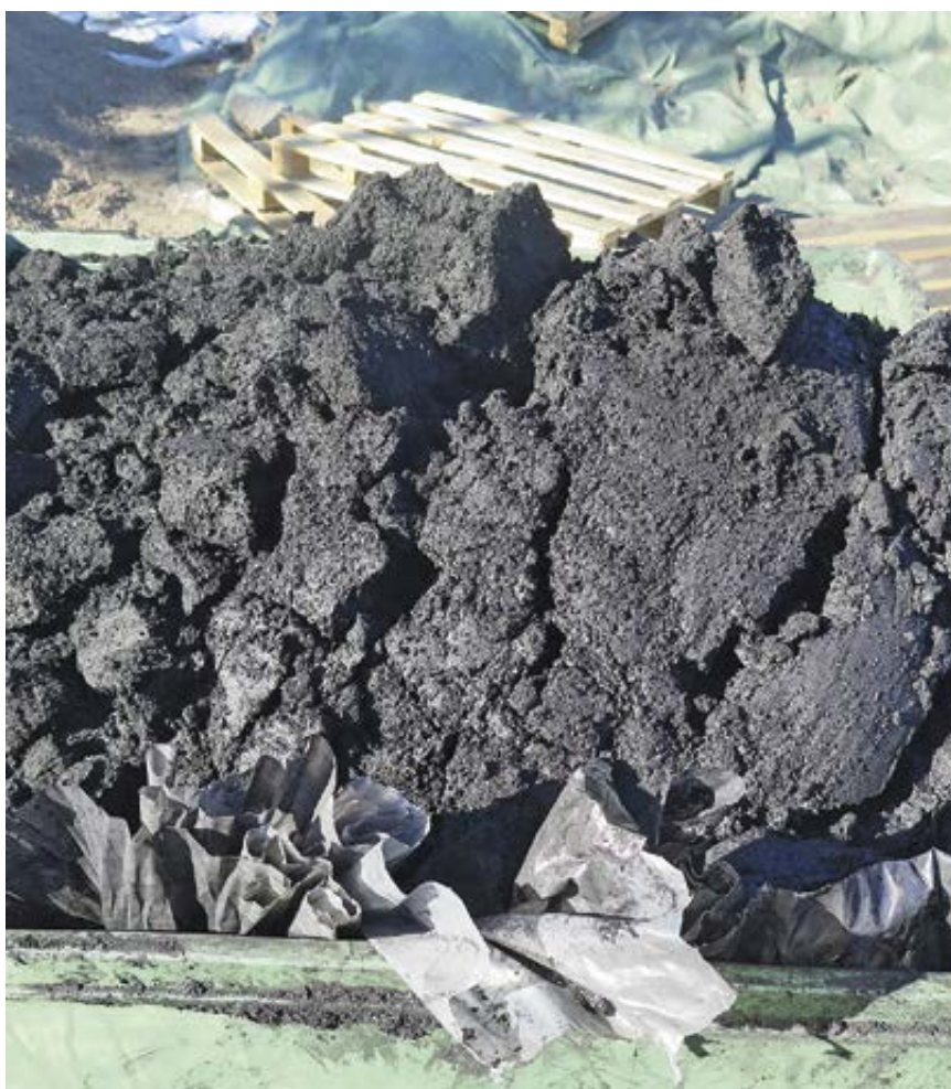
Das in unseren Versuchen verwendete Biochar war feinkörnig bis pulverförmig.
